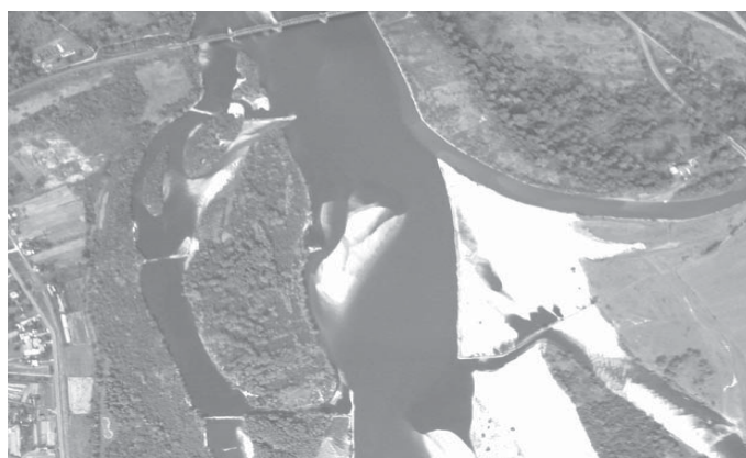
RYSUNEK 6. Sedymentacja rumowiska rzeczno- przy ujściu Wieprza do Wisły FIGURE 6. Deposition of sediment near Wieprz and Vistula confluence
