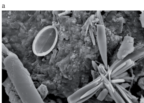
RYSUNEK 9. Zdjęcia skaningowe mikrozanieczyszczeń z wody rzecznej odłożonych na powierzchni geowłókniny (a) i w jej wnętrzu (b) wykonane przy powiększeniu odpowiednio 1000 i 200× FIGURE 9. Scanning photos of microimpurity from the river water accumulated above (a) and inside geotextile (b) in magnification range 1000 and 200×
