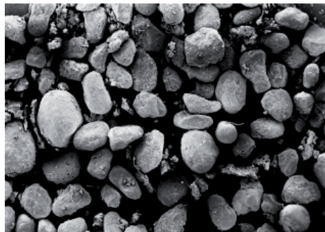
RYSUNEK 10. Zdjęcie skaningowe złoża pod geowłókniną wykonane przy powiększeniu 50× FIGURE 10. Scanning photo of the filtering medium under geotextile in magnification range 50×
