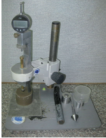
RYSUNEK 2. Oznaczenie granicy płynności ( w_L ) przy użyciu penetrometru stożkowego FIGURE 2. Determination of liquid limit ( w_L ) by cone penetrometer
