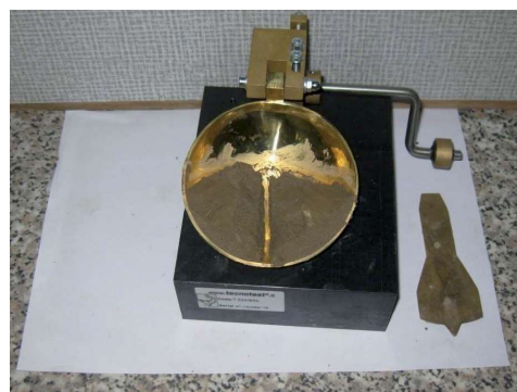
RYSUNEK 1. Oznaczenie granicy płynności ( w_L ) metodą Casagrandego
